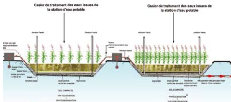
Jardins filtrants ® : coupe de principe
