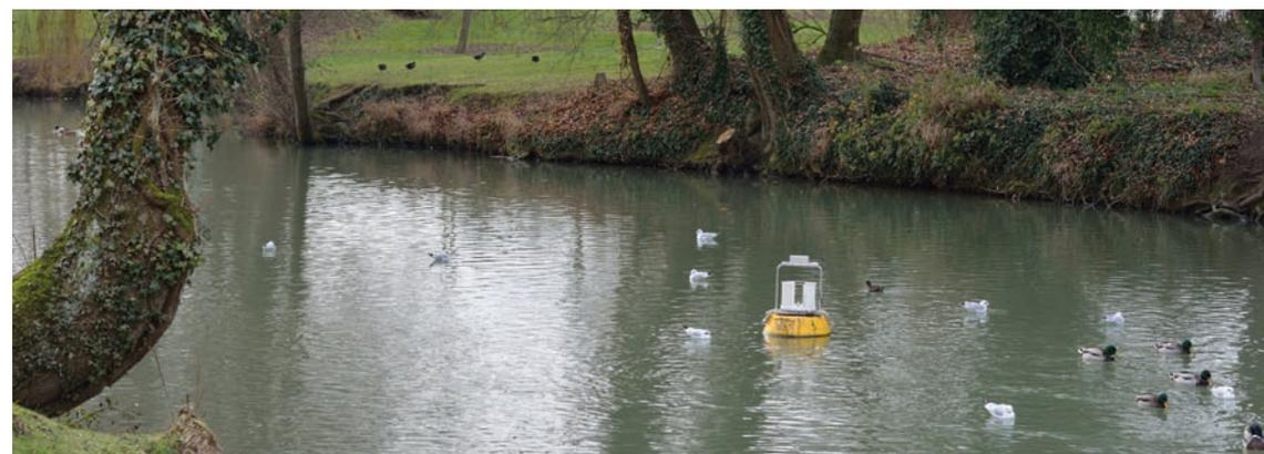
Les bouées SWARM avec capteurs intégrés - un outil innovant pour analyser les ressources en eau.
